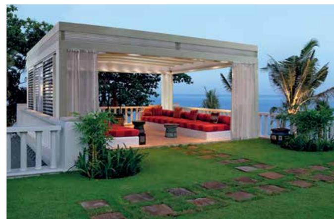
Sopra: la pergola R200 Pergolife, installata nel Golf Club di Carimate, è dotata di una struttura autoportante in alluminio con raccolta acqua integrata nei montanti e copertura mobile in tessuto PVC oscurante ignifugo. Per questo progetto è stata integrata da tre tende a cassonetto a scomparsa totale R93 Elegance, arricchita da sofisticati sistemi micrometrici di regolazione del cassonetto e dei bracci, per una rapida installazione
